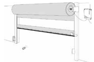
Exemplo instalação em porta rápida com quadro de comando eRADIOBANDRU.
